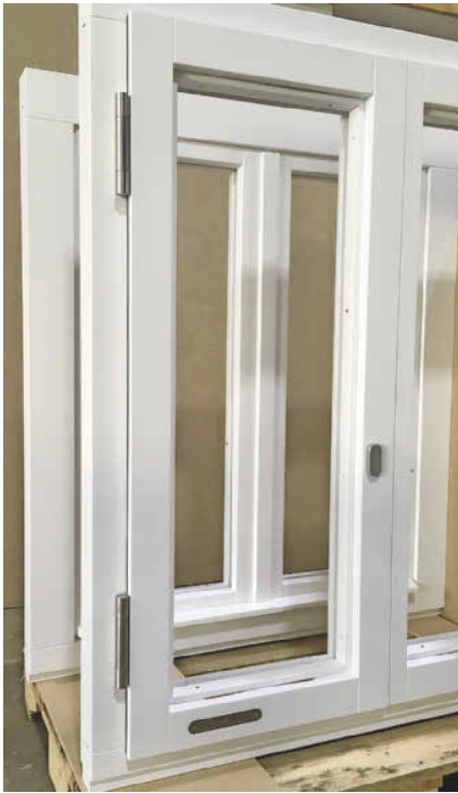
/ Brandschutzfenster vor der Auslieferung: Die Verglasung erfolgt wegen des Gewichts i. d. R. vor Ort.
